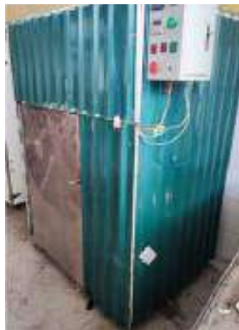
Hình 9. Máy sấy chuối năng suất 30 kg/mẻ.
