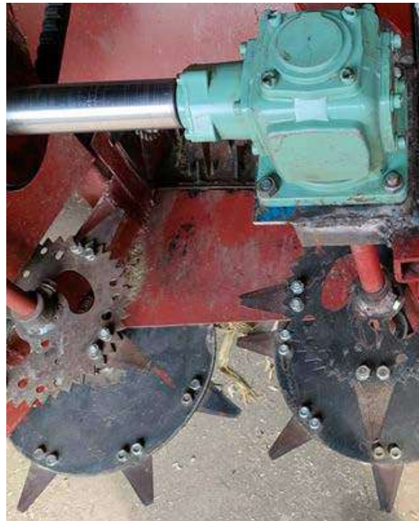
Hình 3. Chế tạo bộ phận cắt cây khóm
