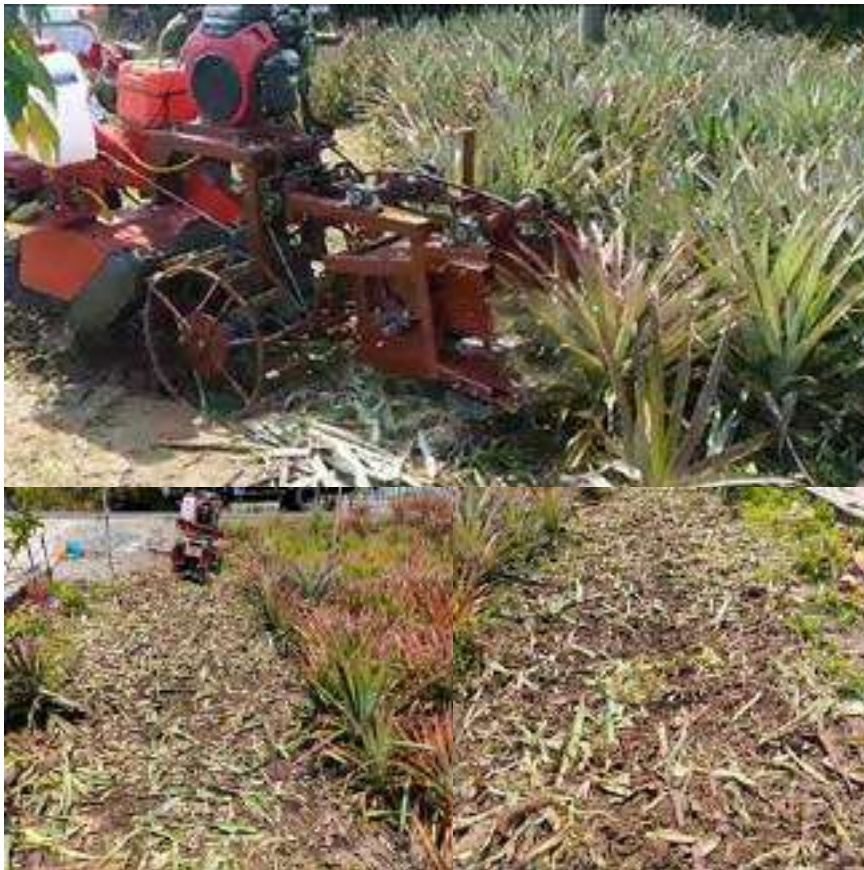
Hình 13. Khảo nghiệm máy cắt băm tại ruộng khóm ở Hậu Giang
