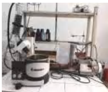
Hình 2.3. Mô hình cô quay chân không tuần hoàn
