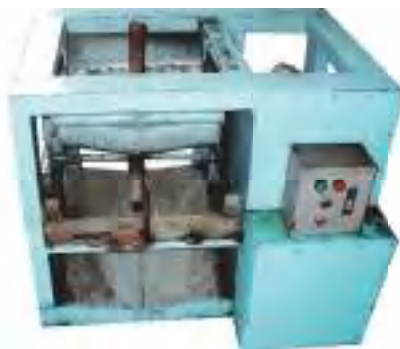
Hình 6. Máy bóc vỏ dừa khô được chế tạo hoàn chỉnh
