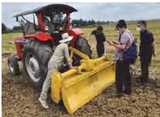
Hình 6. Thử nghiệm đo công suất cản riêng của đất khi phay
