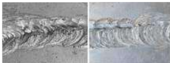
a) b) Hình 13. Đường hàn ứng với tốc độ quay đầu hàn lần lượt 345 vòng/phút (a) và 1100 vòng/phút (b)
