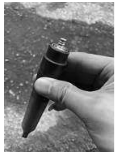
Hình 8. Dạng đầu hàn số 2 đã thiết kế và chế tạo
