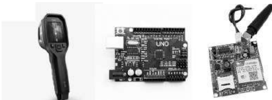
Hình 2. Phần cứng trong hệ thống tự động phát hiện sự tăng thân nhiệt trên vật nuôi
