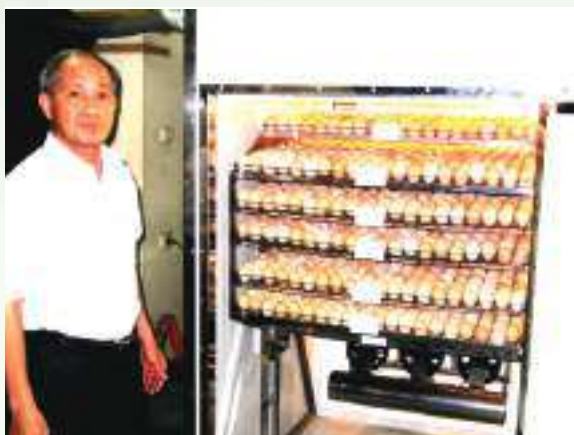
Máy ấp trứng gia cầm ATMG-3000 sử dụng phối hợp NLMT và khí sinh học
