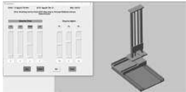
Hình 8. Mô hình 3D ở vị trí home ứng với giá trị 0 của các biến khớp
