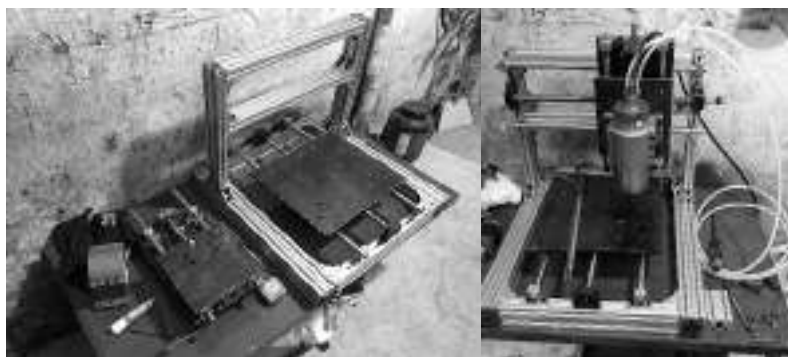
Hình 5. Lắp đặt phần khung máy và bàn máy
