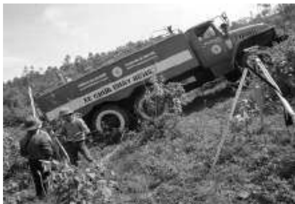
Hình 1. Khảo nghiệm xe di động trên dốc dọc và dốc ngang
