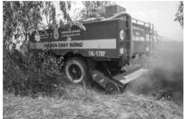
Hình 2. Khảo nghiệm khả năng làm băng trắng cách ly khoanh vùng cô lập đám cháy đám cháy
