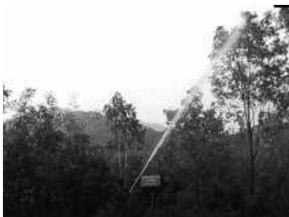
Hình 4: Khảo nghiệm khả năng dập lửa bằng hệ thống phun nước
