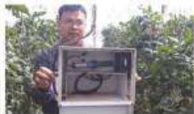
Bộ cảm biến đo độ ẩm không khí lắp bên trong nhà kính trồng cà chua Công nghệ Israel Tại Trung tâm
