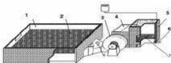
Hình 3. Sơ đồ nguyên lý máy sấy giường
