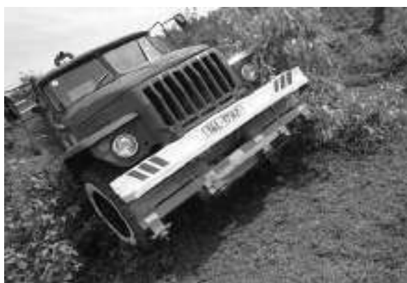
Hình 1. Khảo nghiệm xe di động trên dốc dọc và dốc ngang
