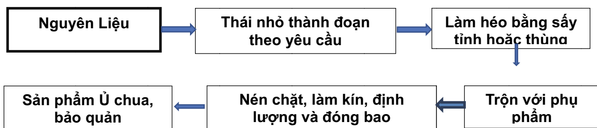
Hình 6. Qui trình chế biến theo phương pháp làm héo và ủ chua
