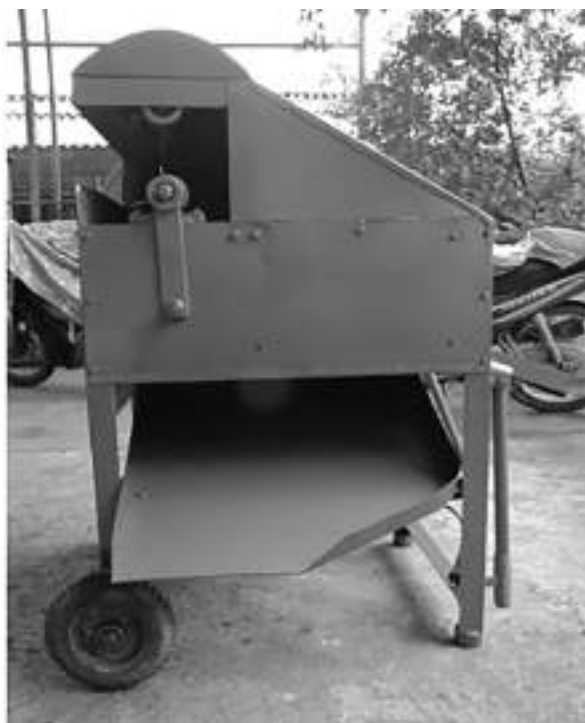
Hình 7. Máy bứt củ lạc (BCL-200) với nguyên lý bộ phận đập ngang trực kiểu trống thanh
