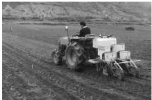
Hình 3: Máy gieo kết hợp bón phân, phun thuốc BVTV 2 hàng liên hợp với máy kéo 20-35 HP
