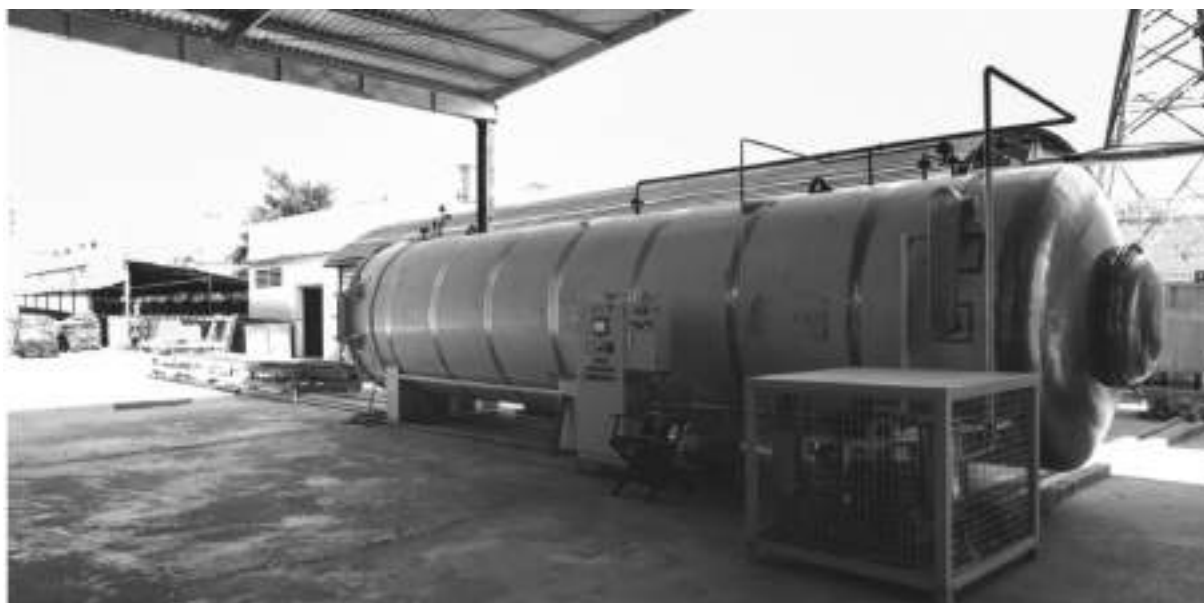
Hình 4. Mô hình thiết bị sấy gỗ bằng bơm nhiệt chân không, quy mô 8-10 m 3 (Lắp đặt hoàn thiện tại Pisico, KCN Phú Tài, Quy Nhơn, Bình Định)
