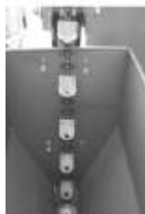
a) Gầu lấy củ kiểu xích tải; b) Xả phân kiểu cánh gạt bằng nhựa
