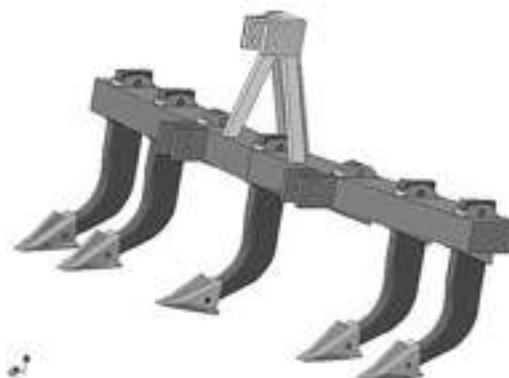
Hình 1: Máy cày ngầm Một số chỉ tiêu kỹ thuật của máy Năng suất: 0.3 – 0.5 ha/h; Số mũi đục 3-5 cái; Độ sâu: 30-45cm
