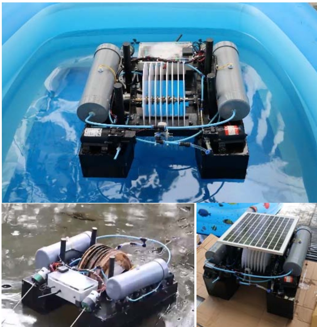
Hình 2. Vận hành thử nghiệm Robot lọc vớt dầu chạy bằng năng lượng mặt trời
