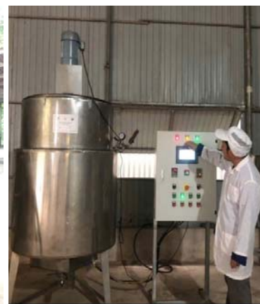
Hình 5. Hệ thống thiết bị điều khiển môi trường nuôi giun Hình 6. Hệ thống TB thủy phân
