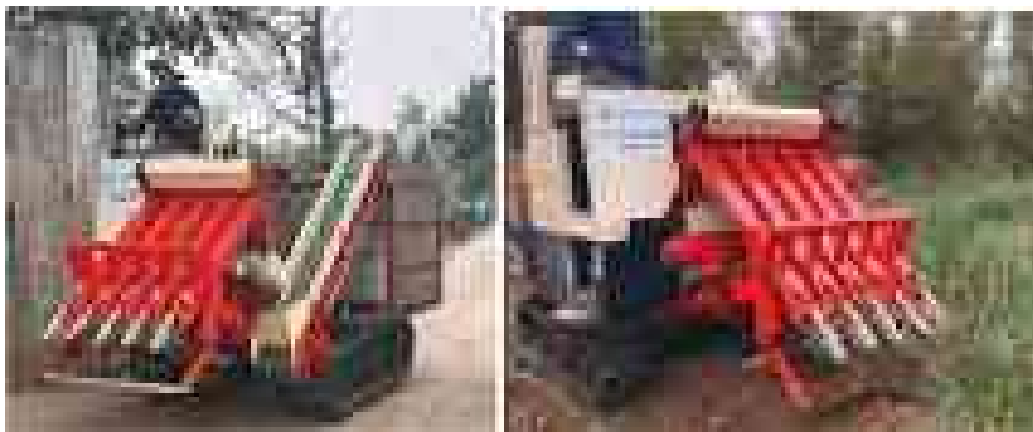
Hình 7. Máy thu hoạch hành củ, tỏi theo hàng
