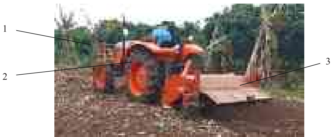
1. Bộ phận làm đổ cây; 2. Máy kéo bốn bánh; 3. Máy băm dạng lô; Hình 5.4. Máy băm dạng lô liên hợp với máy kéo
