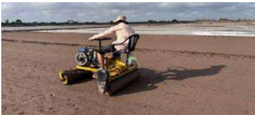
Hình 3.6: Sử dụng máy lu lèn làm sân kết tinh muối
