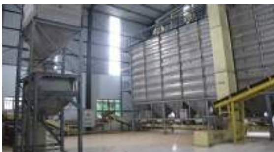
Công nghệ và thiết bị sấy lại, bảo quản và định lượng, phối trộn chè đen CTC bằng tổ hợp silo phục vụ xuất khẩu
