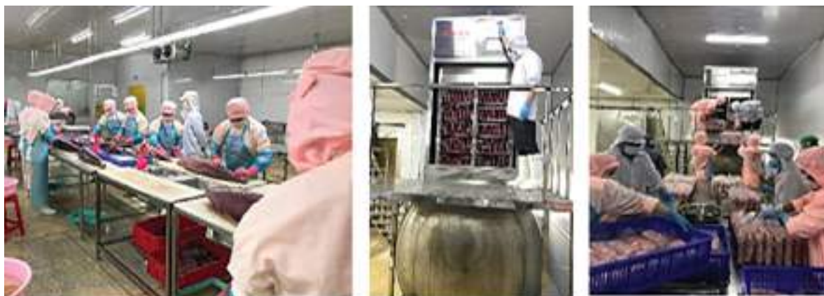
Công nghệ và thiết bị cấp đông siêu tốc bằng chất lỏng, năng suất 500 kg/giờ
