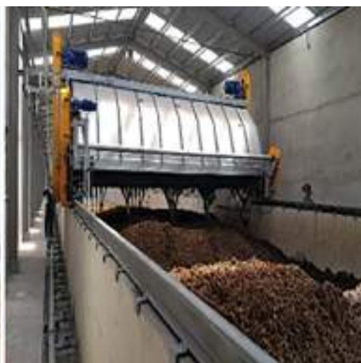
Hệ thống thiết bị và công nghệ xử lý phân gà công suất 2m 3 /ngày
