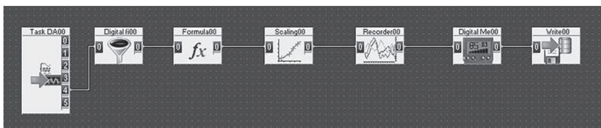
Hình 3. Sơ đồ kết nối các Module xử lý tín hiệu thu nhận
