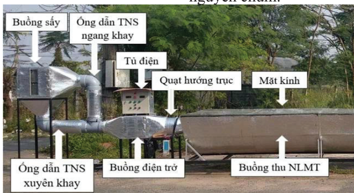
Hình 17. Máy sấy nho chùm nguyên cành sử dụng NLMT
