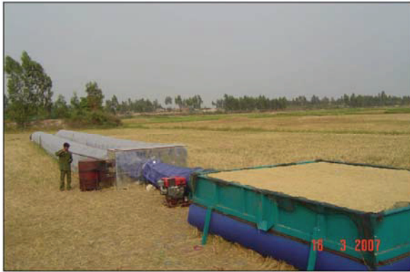
Hình 13. Máy sấy lúa sử dụng NLMT và đồ thị thông số kỹ thuật trong quá trình sấy
