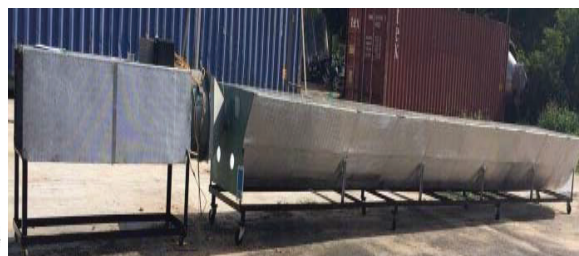
Hình 16. Máy sấy cá lù đù một nắng sử dụng năng lượng mặt trời
