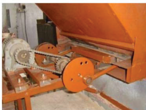
a. Cơ cấu piston cung cấp trấu
