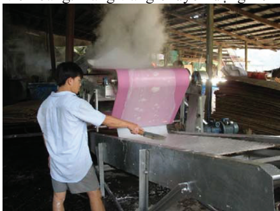
Hình 3. Máy tráng bánh và sấy bánh hủ tiếu
