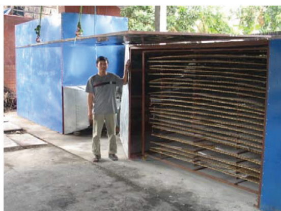
Hình 3. Máy tráng bánh và sấy bánh hủ tiếu
