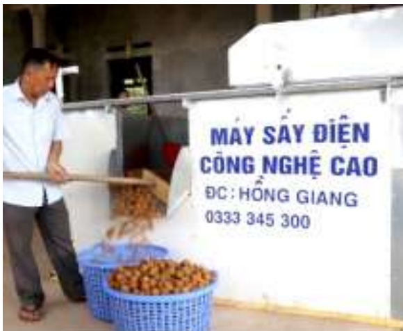
Hình 3. Thiết bị sấy vải thiều sử dụng năng lượng nhiệt/điện trở
