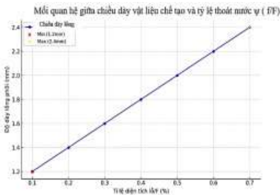
Hình 7. Đồ thị quan hệ giữa chiều dày vật liệu ( \delta ) chế tạo và tỷ lệ thoát nước ( \psi )
