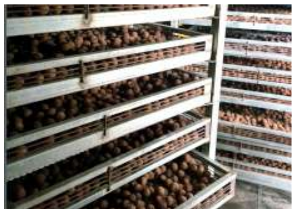
Hình 2. Hệ thống sấy vải thiều sử dụng nhiệt từ lò hơi
