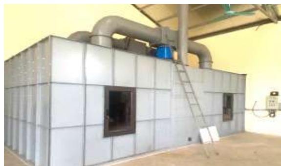
Hình 5. Mô hình sấy sử dụng nhiệt gián tiếp từ nhiên liệu sinh khối [1]
