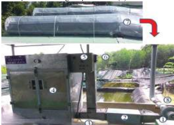
Hình 15. Máy sấy cá dứa sử dụng NLMT
