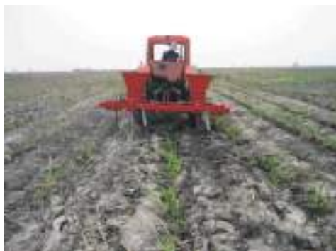
Hình 13 & 14. Máy chăm sóc mía phục vụ cơ giới hóa cây mía
