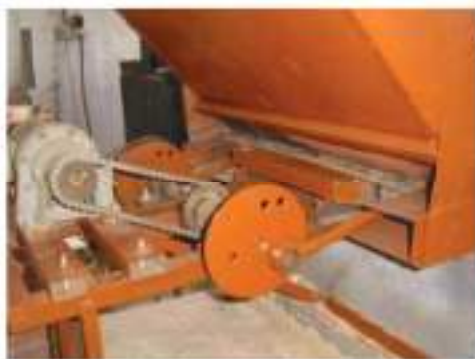
a. Cơ cấu piston cung cấp trấu
