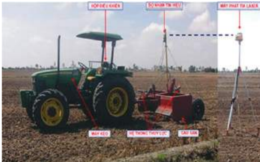
Hình 1. Hệ thống san phẳng đồng ruộng điều khiển bằng tia laser
