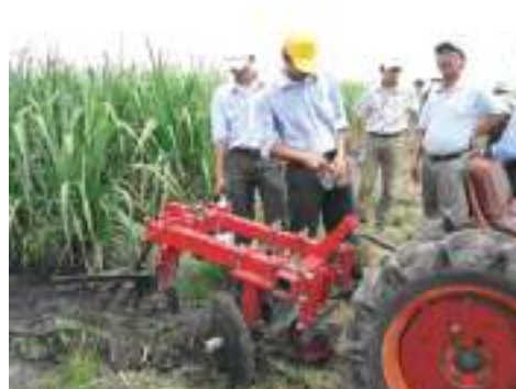
Hình 13 & 14. Máy chăm sóc mía phục vụ cơ giới hóa cây mía
