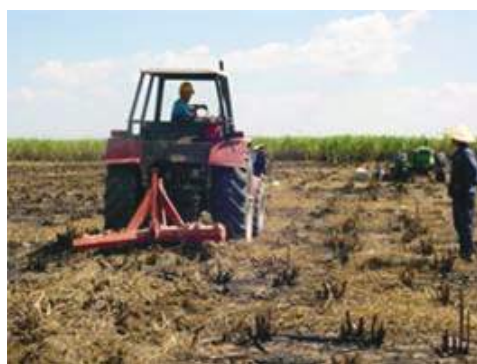
Hình 4 & 5. Cày ngầm phá gốc mía tại La Ngà và được cải tiến để chăm sóc cây cao su
