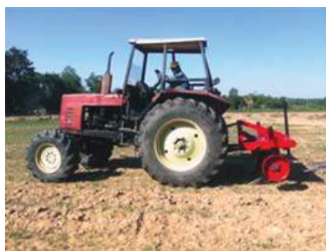
Hình 4 & 5. Cày ngầm phá gốc mía tại La Ngà và được cải tiến để chăm sóc cây cao su
