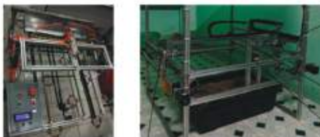
a. Khâu gieo hạt tưới b. Cơ cấu định vị tọa độ tự động Hình 6.5. Thiết bị chăm sóc cây trồng trên khay tự động
