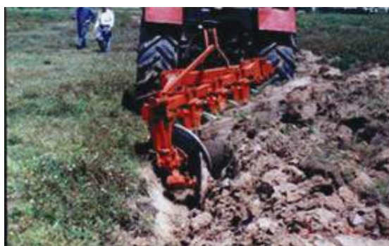
Hình 2 & 3. Máy cày phá lâm 4 chảo làm việc tại Tây Ninh
