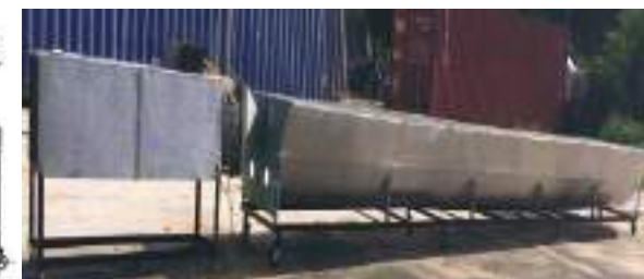
Hình 16. Máy sấy cá lù đù một nắng sử dụng năng lượng mặt trời
