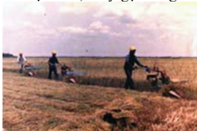
Hình 7. (a) Máy gặt xếp dây, do xưởng cơ khí Long An chế tạo năm 1985 [5], và (b) Mẫu máy còn lại đến năm 2004
