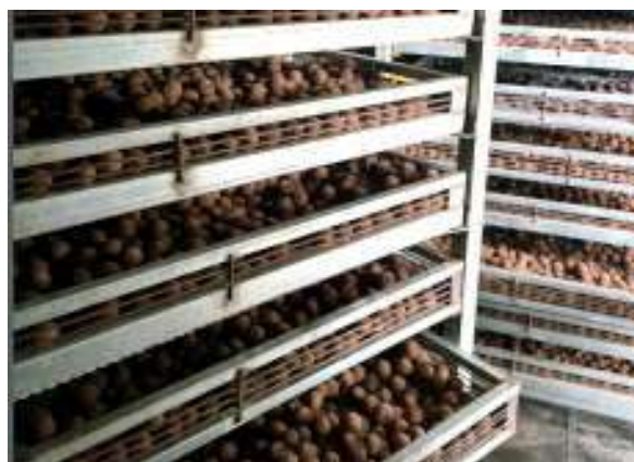
Hình 2. Hệ thống sấy vải thiều sử dụng nhiệt từ lò hơi
