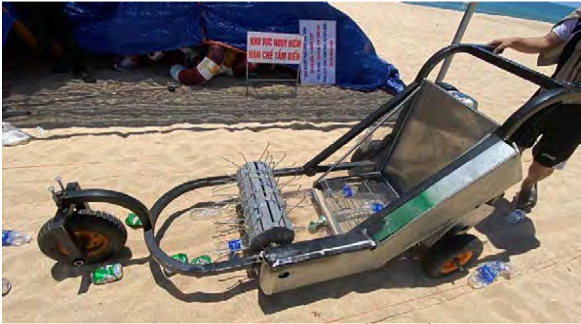
Hình 3. Máy dọn rác trên bãi biển sau chế tạo
