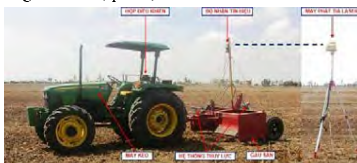
Hình 5: Liên hợp máy san phẳng laser và máy kéo 55 HP [13]
