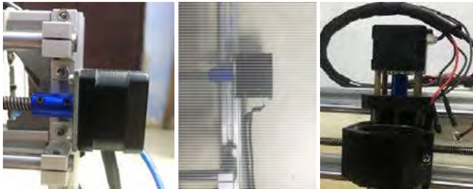
Hình 7. Động cơ bước gắn trên các trục X (trái), Y (giữa), Z (phải)
