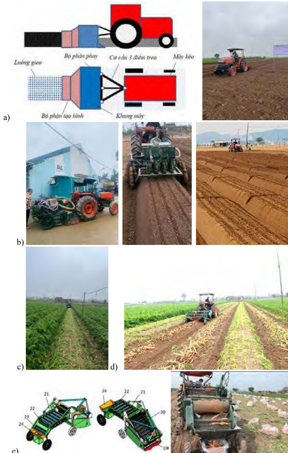
Hình 1. Hệ thống thiết bị cơ giới hóa đồng bộ sử dụng trong mô hình a) Máy làm đất lên luống, b) Máy gieo hạt cà rốt kết hợp bón phân, c) Máy cắt băm lá cà rốt, d) Máy đào củ cà rốt, e) Máy thu gom củ
