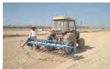
c: Thiết bị sạ khô ứng dụng trên đồng ruộng đã san phẳng laser [15]
