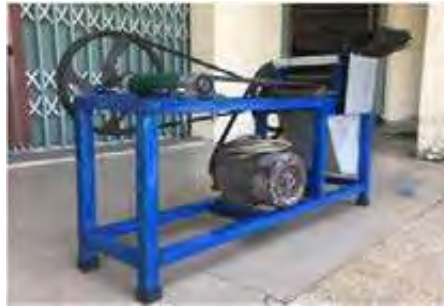
Hình 3. Mẫu máy cán bột mì sau khi chế tạo
