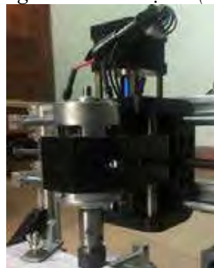
Hình 8. Động cơ trục chính (Động cơ DC 775 gắn theo trục Z)
